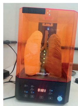
Fig. 13: Cura das junções em máquina UV.
