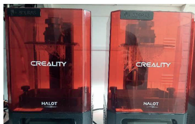
Fig. 10: Partes dos bronquíolos sendo impressas simultaneamente em duas impressoras de resina.
