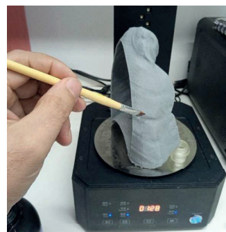
Figura 8: Um dos pulmões impresso e recebendo aplicação em resina para reforço de camada.
