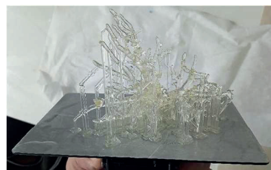
Fig. 11: Um dos conjuntos impressos, ainda com os suportes fixados à plataforma de impressão.
