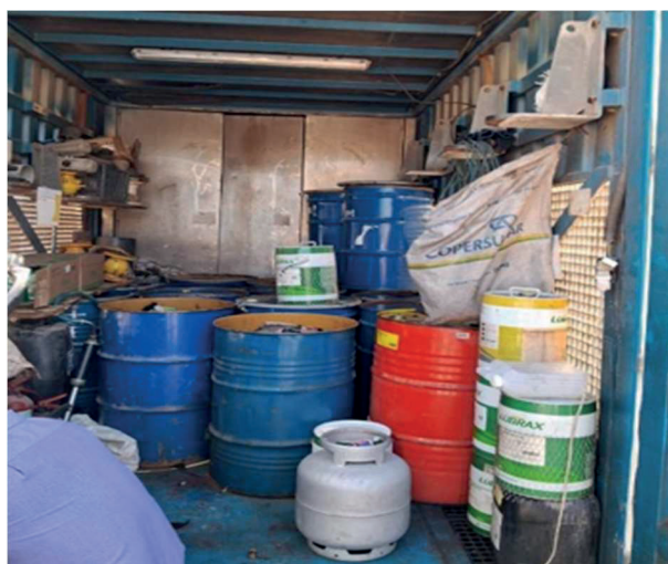
Figura 8. Armazenamento inadequado de químicos em container .
