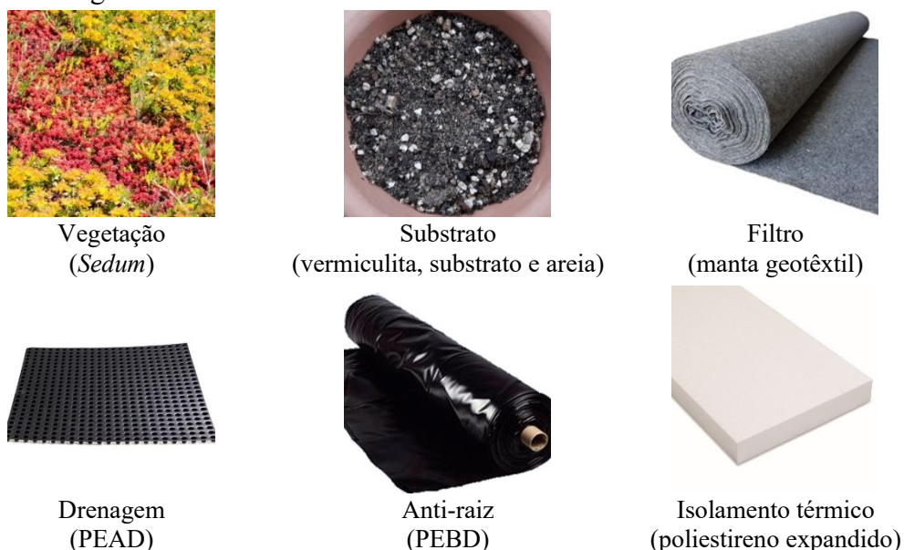
Figura 12 - Materiais utilizados nas camadas da cobertura verde
