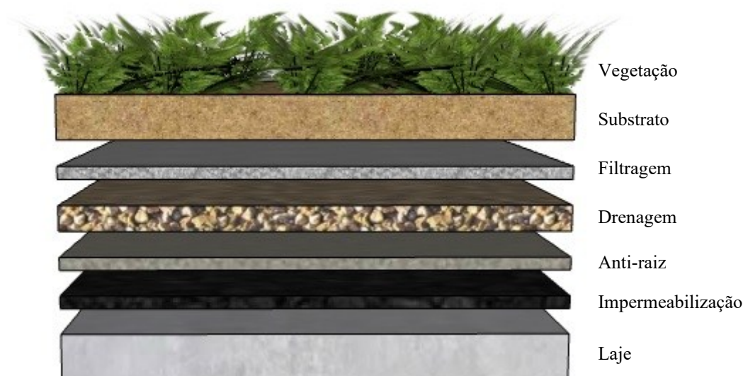
Figura 1 - Camadas básicas de uma cobertura verde
