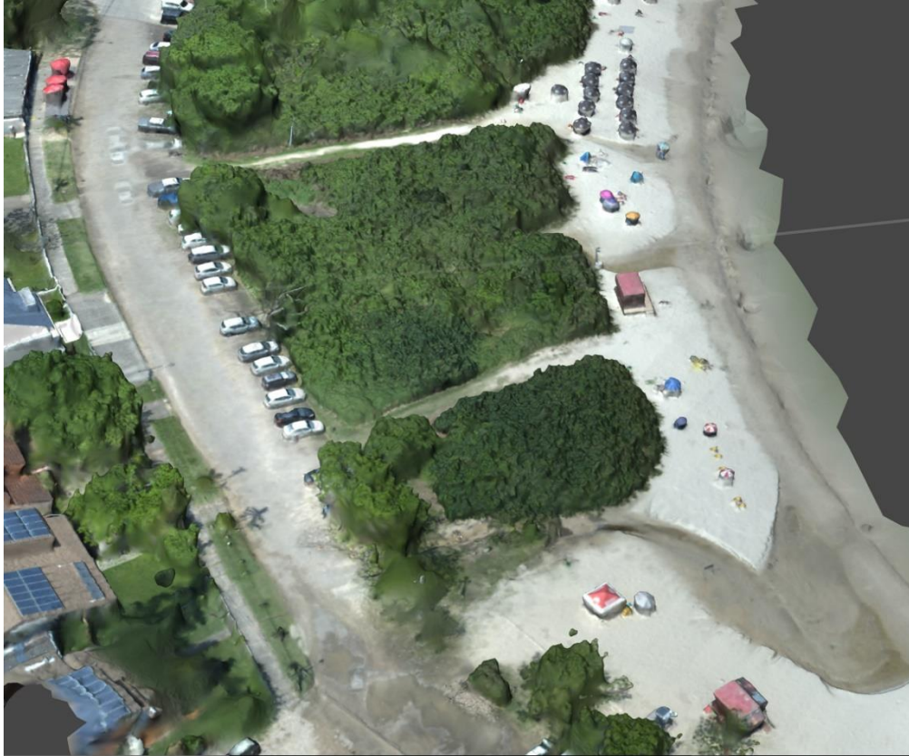
Figura 14 - Modelo 3D obtidos com RPA do levantamento 1
