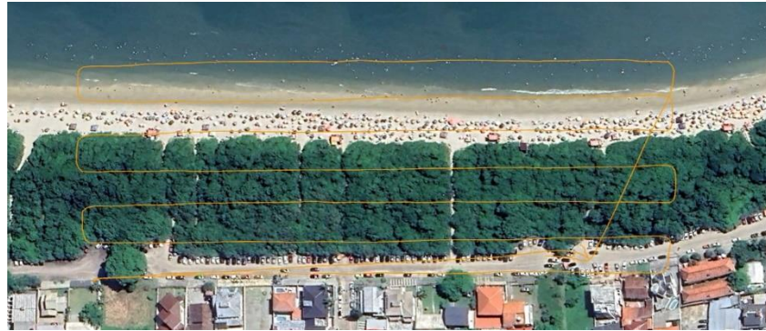
Figura 3 - Plano de voo gerado pelo Map Pilot Pro do segundo levantamento
