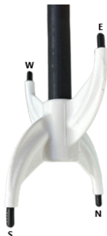
Figura 2 – Exemplo de sonda de fluxo de calor utilizada em STMFs.
