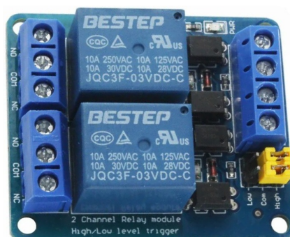
Figura 17 – Módulo relé 2 canais.
