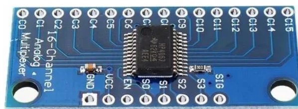
Figura 15 – Módulo multiplexador CD74HC4067.
