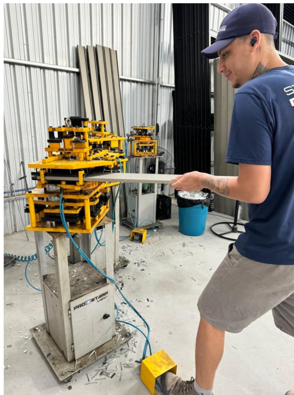
Figura 14 – Operário realizando a usinagem de um perfil de alumínio utilizando um estampo pneumático
