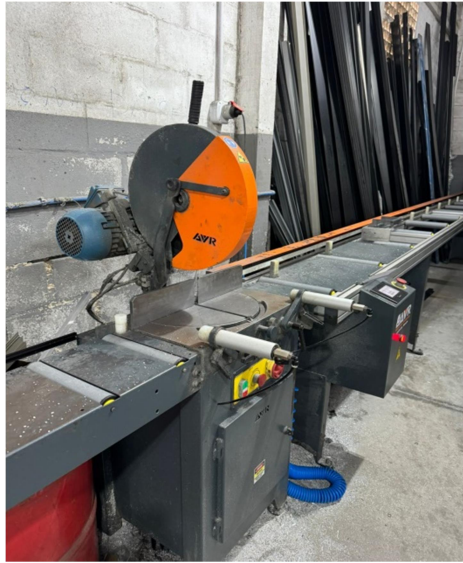
Figura 13 – Serra circular para corte dos perfis de alumínio
