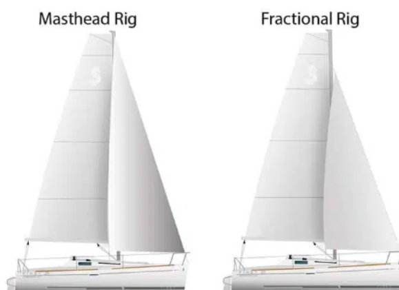
Figura 13 – Estaiamento de Mastro de Topo e de Mastro Fracionado.
