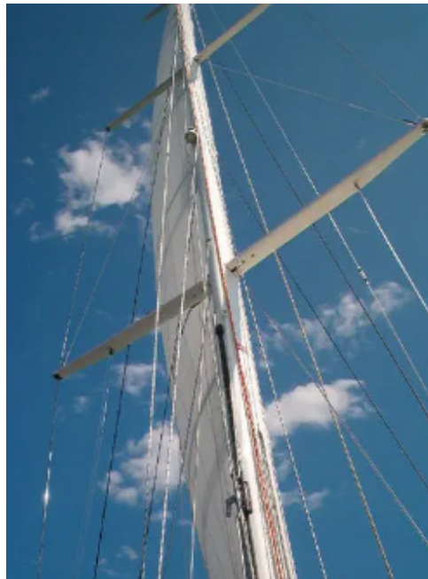
Figura 11 – Estaiamento com Cruzetas e Multiestaiamento.
