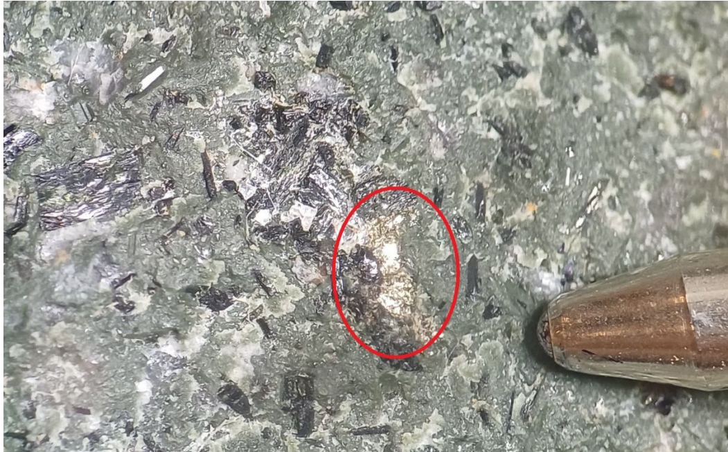
Figura 7 - Foto da pirita vista em lupa, escala: ponta de caneta esferográfica.
