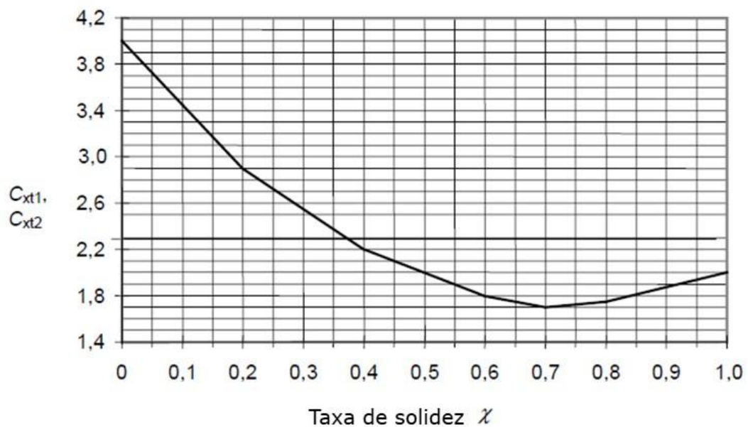
Figura 10 - Coeficientes de arrasto para suportes treliçados compostos por membros de faces planas
