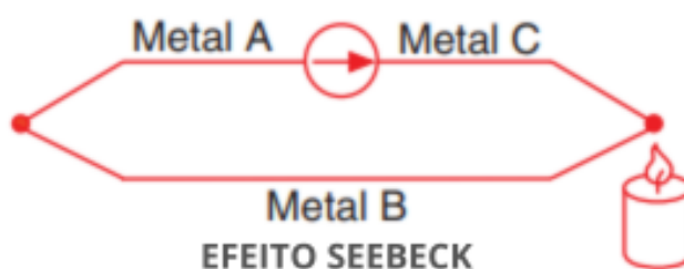
Figura 6 – Operação de um termopar
