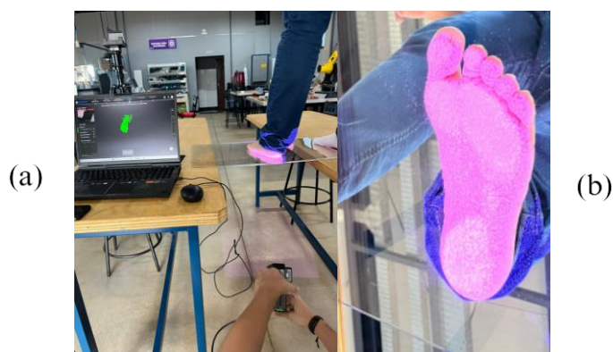
Figura 5: Processo de escaneamento: (a) scanner sendo utilizado e (b) vista posterior do pé ao ser escaneado. Fonte: Autores.
