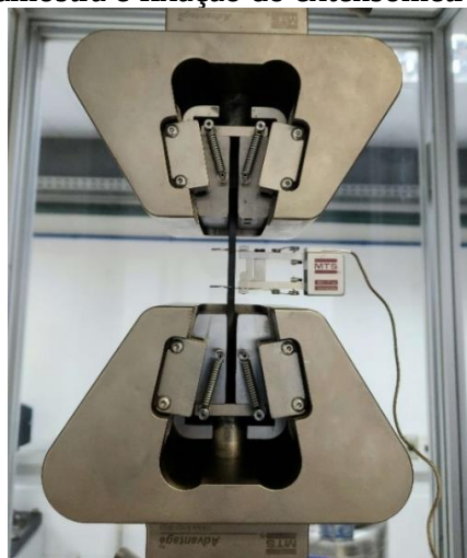
Figura 33 – Disposição da amostra e fixação do extensômetro durante o ensaio de tração.
