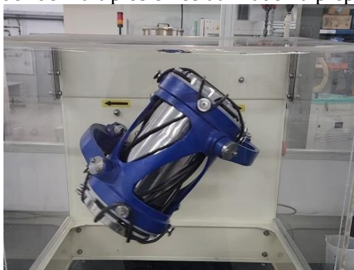
Figura 24 - Misturador de múltiplos eixos utilizado na preparação do feedstock .
