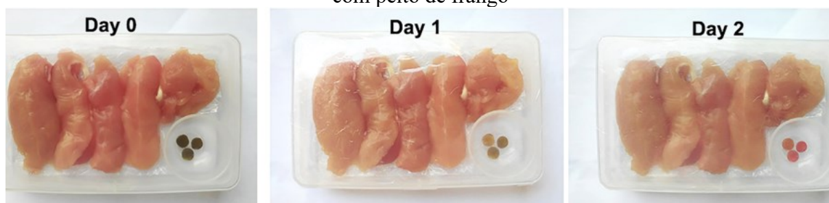
Figura 7 – Indicador de frescor contendo vermelho de metila e azul de bromotimol em testes com peito de frango
