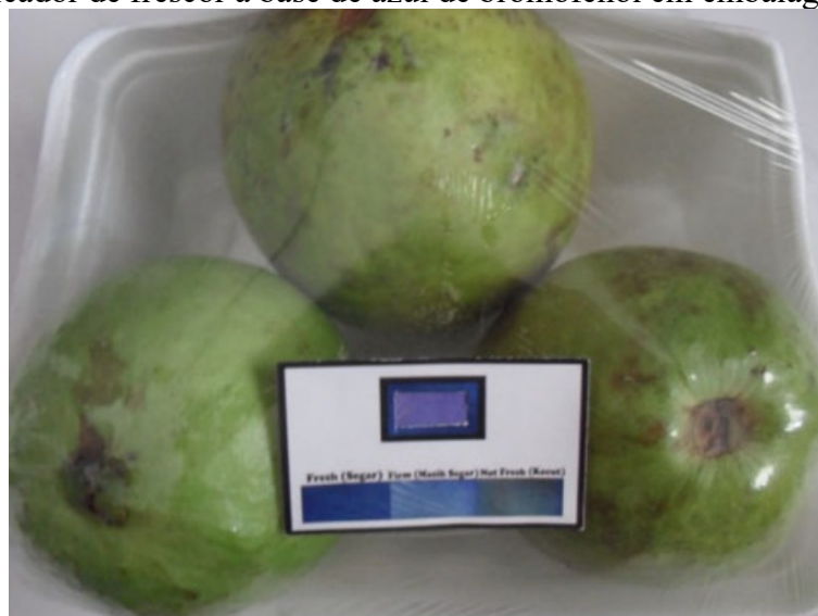
Figura 6 – Indicador de frescor a base de azul de bromofenol em embalagem com goiabas
