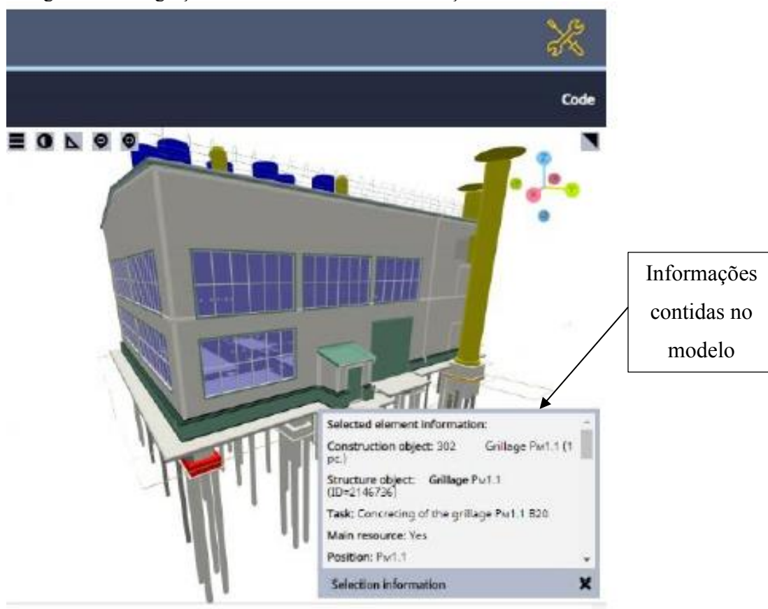
Figura 18 - Integração entre modelo BIM e informações de rastreamento
