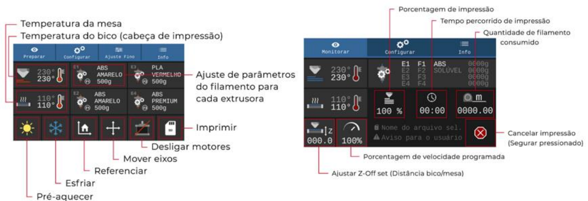
Figura 37: Funções nos display LCD das impressoras GTMax
