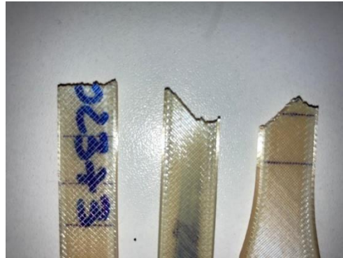
Figura 63: Modo de fraturas das demais fraturas, CDP01 e CDP15
