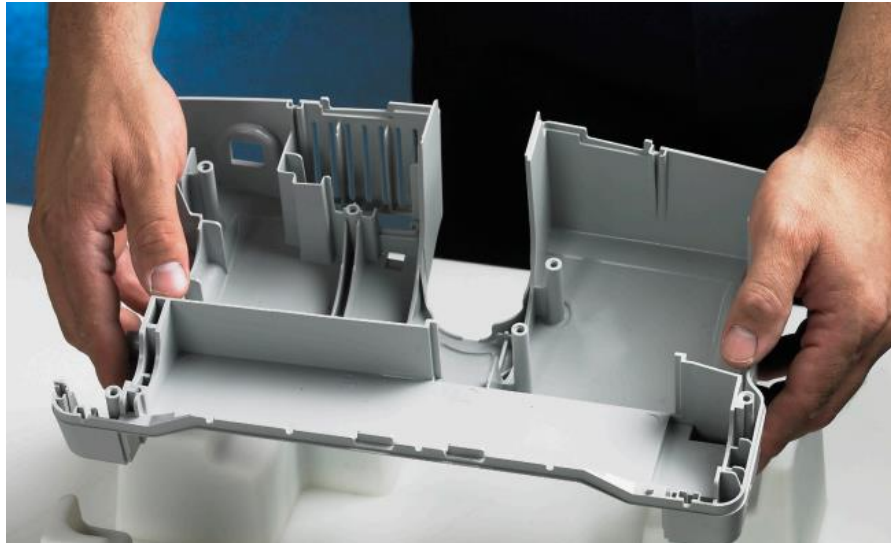
Figura 40: Exemplo de Prótipo desenvolvido pela impressora 3D Stratasys Fortus 450mc
