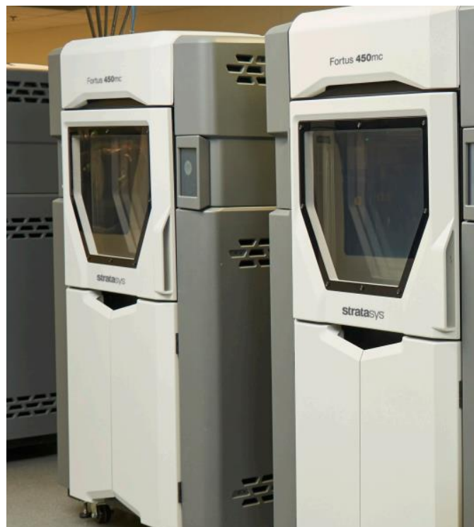
Figura 39: modelo de impressora 3D Stratasys Fortus 450mc.
