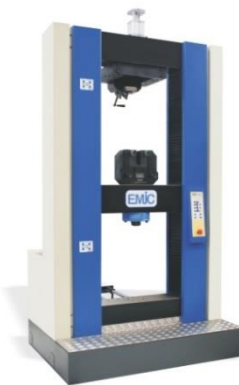
Figura 52: a máquina de modelo EMIC DL10000 para a realização dos Ensaios de Tração
