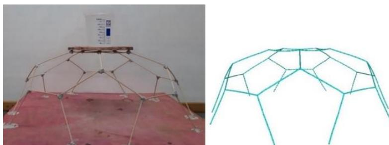
Figura 6: Geodésica com carregamento vertical e modelo tridimensional nas mesmas condições.
