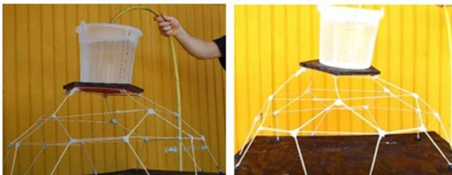
Figura 15: Estruturas geodésicas de bambu com reforço amarrado próximas do momento de colapso.
