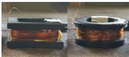
Figura 8 – Sensores Tipo I confeccionados com formatos quadrado e circular.
