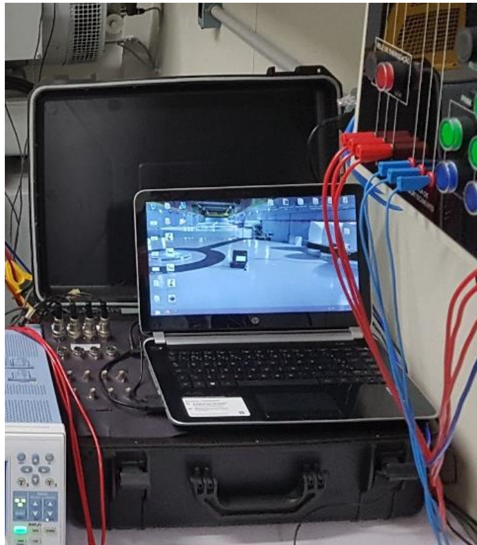
Figura 33 – Maleta contendo circuito de condicionamento e de aquisição.
