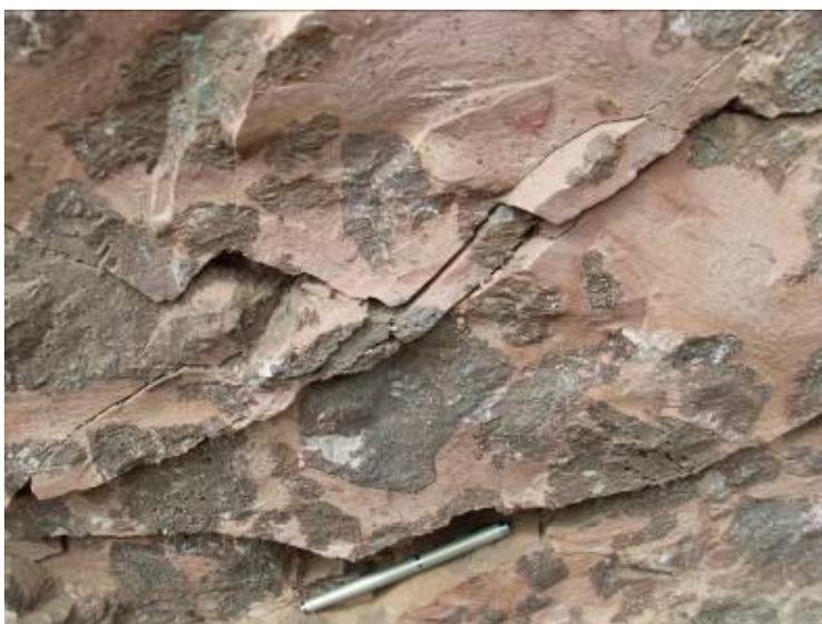
Figura 3: Brecha “peperítica” no contato entre derrames da Serra Geral, revelada na escavação da casa de força da UHE Foz do Chapecó, no rio Uruguai. Maio de 2008. (Foto Luiz Fernando Scheibe).
