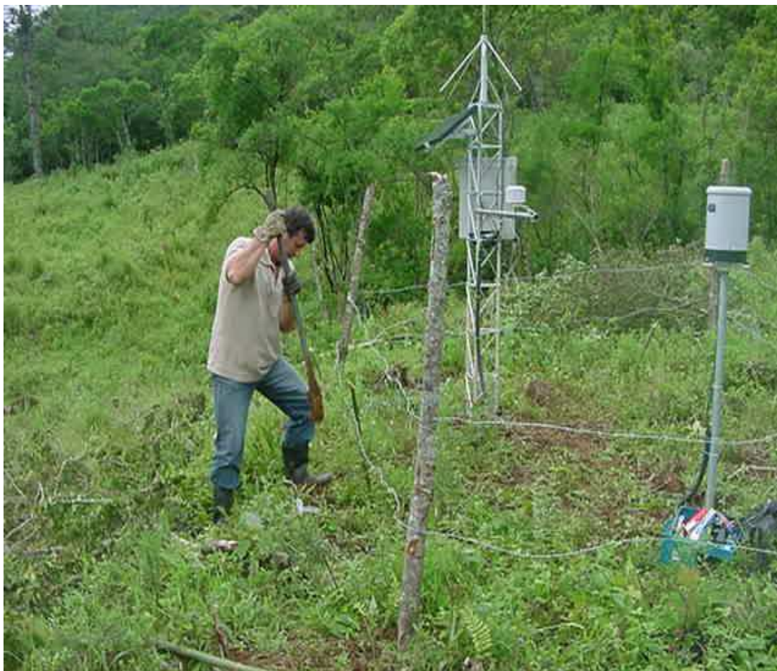
Figura 3 – Instalação da estação meteorológica na Serra da Rocinha no dia 20 de dezembro de 2004, com cercamento provisório.
