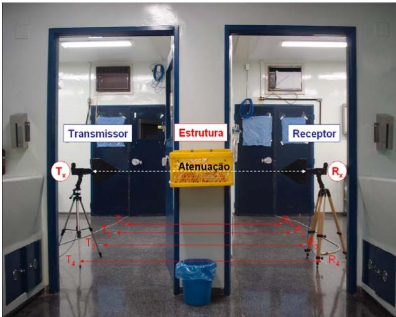
**Figura 5-22: Ensaio para Caracterização de Estruturas no Hospital Alfa.**
