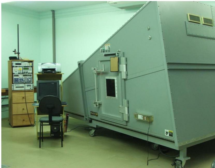
**Figura 4-6: Célula GTEM 5411 (ETS Lindgren) para Ensaio de Emissões Radiadas.**
