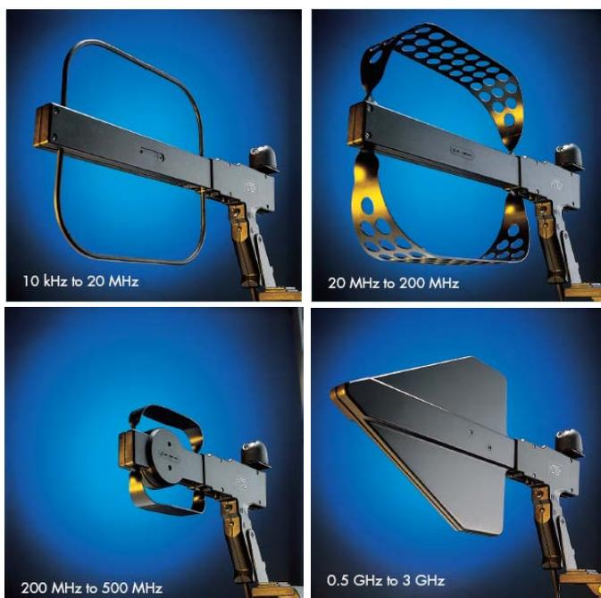
**Figura 4-4: Antenas Utilizadas para Medição de Campo Elétrico - HE-200 (Rohde & Schwarz).**
