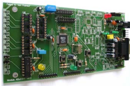
Figura 4.9 - Placa de aquisição desenvolvida.
