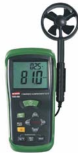
Figura 3.7 - Medidor de velocidade do ar que utiliza o princípio da ventoinha.
