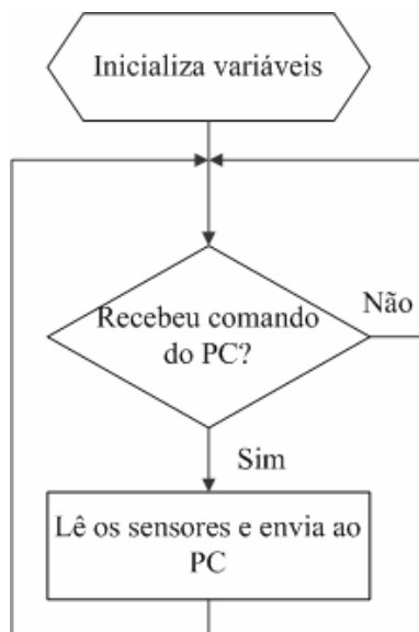
Figura 4.11 – Descrição do diagrama principal do firmware .
